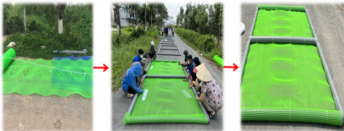
Hình 10: Quy trình cố định lưới vào khung bè
