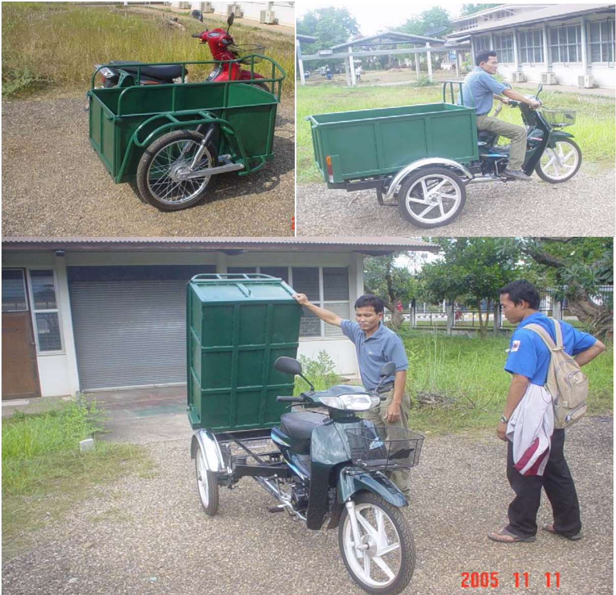
ຮູບ 2.9 ສາມລັດສຳລັບຂົນສົ່ງຂີ້ເຫຍື້ອຢູ່ທາງຊອຍແຄບທີ່ນະຄອນຫຼວງວຽງຈັນ ອອກແບບ ແລະຜະລິດ ທົດລອງໂດຍ ມະຫາວິທະຍາໄລແຫ່ງຊາດລາວ 2005
