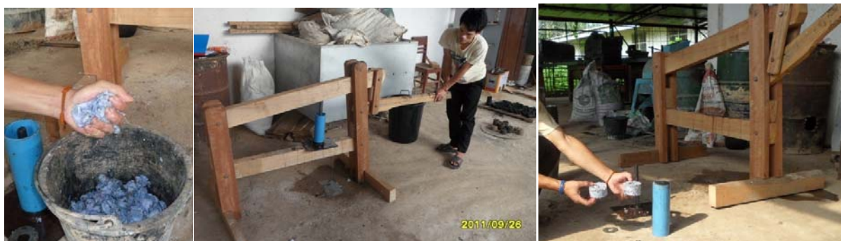
ຮູບ 3.5 ການຜະລິດ ກ້ອນຊີວະມວນຈາກຂີ້ເຫຍື້ອຕ່າງໆໂດຍການໃຊ້ ເຄື່ອງໜີບງ່າຍດາຍ
